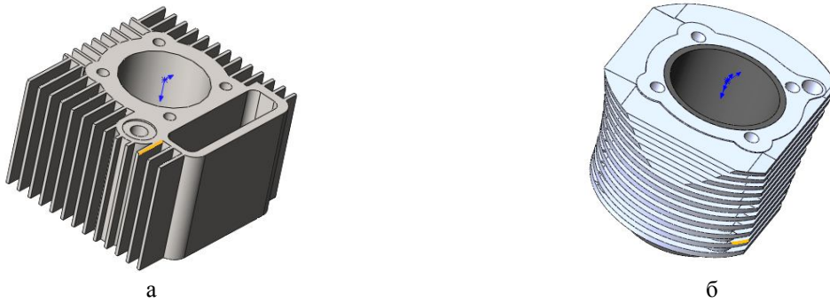
Рис. 5. Гильзы цилиндра: а – прототипа, б - предлагаемого
