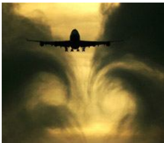
Рис. 5. Визуализация скоса потока между концевыми вихрями
