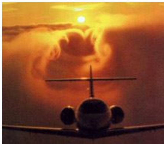
Рис. 5. Визуализация скоса потока между концевыми вихрями
