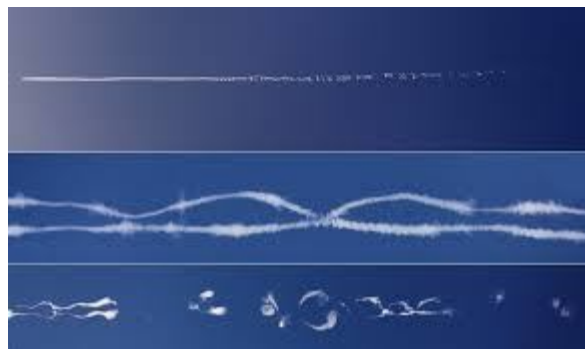
Рис. 6. Разрушение вихревого следа (волновая неустойчивость, “взрыв” ядра концевых вихрей)
