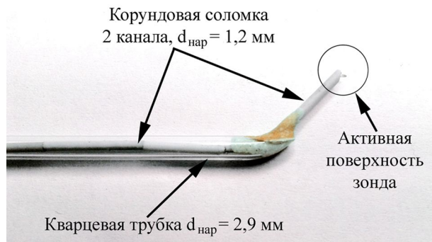
Рис. 4. Нагревный зонд
