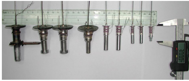
Рис. 3. Линейка катодов-нейтрализаторов: слева направо – М16-20А (1 шт.), М10-5А (2 шт.), М10-2А (3 шт.), М06-05А (3 шт.)
