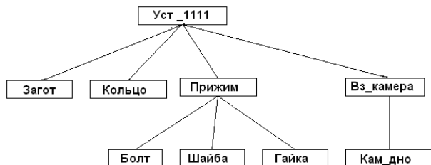
Рис. 4. Графическое представление структуры объекта в СПРУТ ТП
