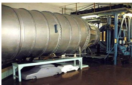
Рис. 1. Аэродинамическая труба Т-3 ХАИ: длина рабочей части – 2,2 м, диаметр сопла – 1,5 м, скорость потока в рабочей части трубы – 0,5 - 45 м/с, начальная степень турбулентности потока – 0,65 %
