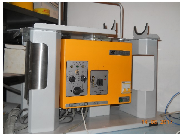
Рис. 2. Установка ХГННД ДИМЕТ-405
