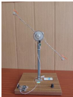
Рис. 3. Экспериментальная установка для изучения особенностей движения конвертоплана
