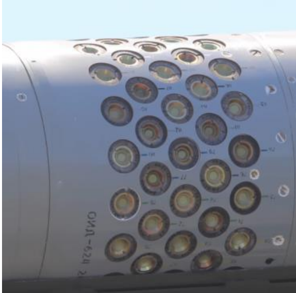
Рис. 1. Рулевые двигатели в корпусе ракеты
