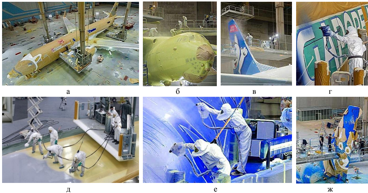
Рис. 8. Приклади застосування стельових краново-телескопічних платформ:
