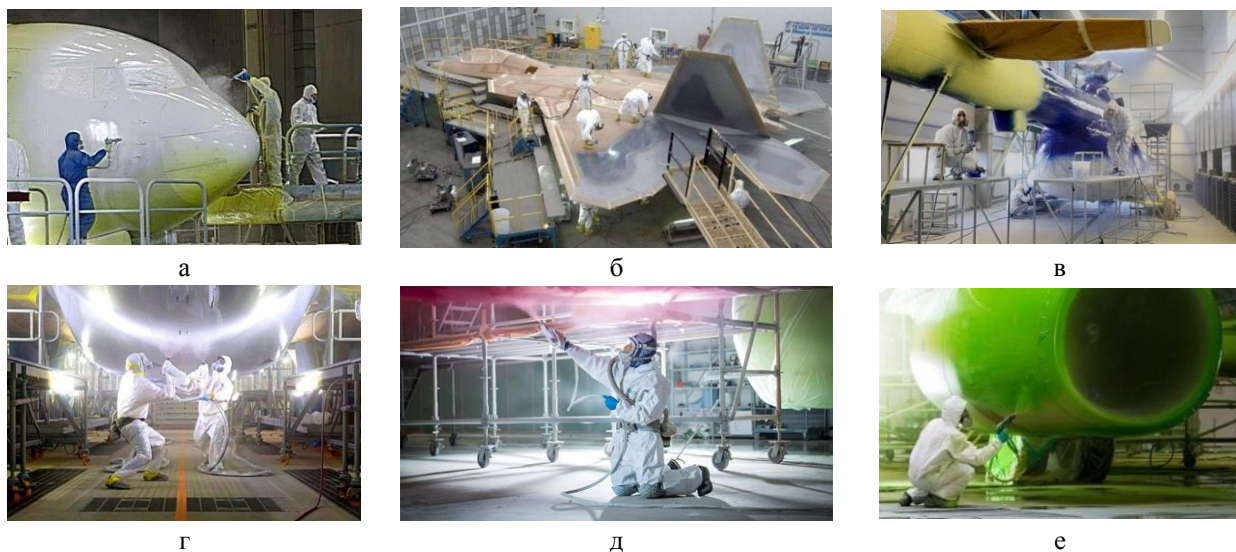
Рис. 2. Приклади пневматичного фарбування деяких виробів АТ: а – аеробуса; б – винищувача; в – вертольота; г, д, е – приклади зовнішніх поверхонь виробів АТ, які незручні для пневматичного фарбування
