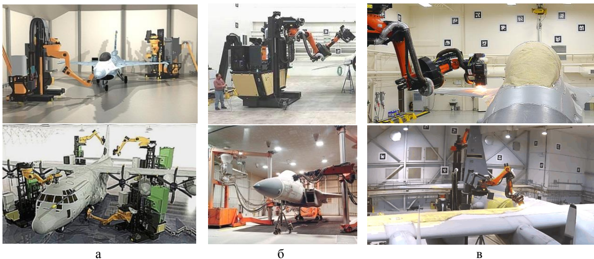
Рис. 12. Комп'ютерні моделі компоновання (а), загальний вигляд (б) та приклади застосування (в) роботизованих стендів для лазерного видалення старого ЛФП із зовнішньої поверхні літаків
