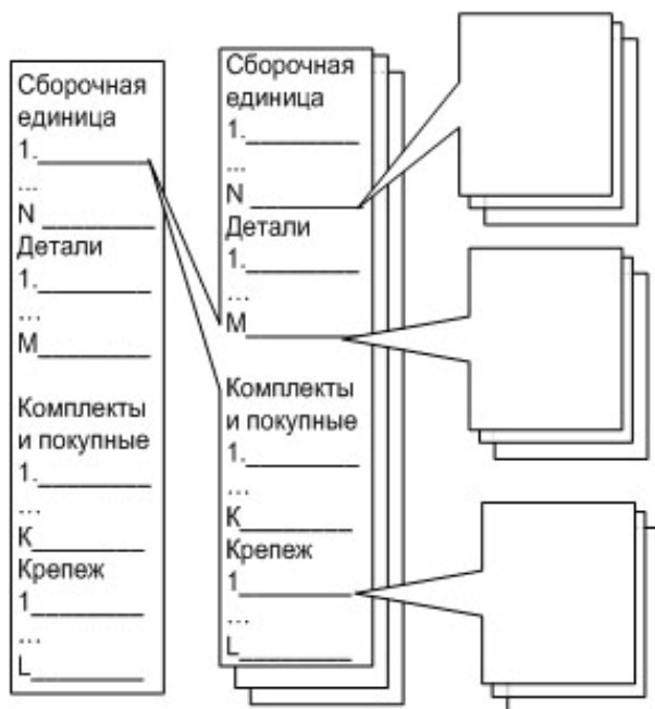
Рис. 1. Представление деталесборочной единицы
