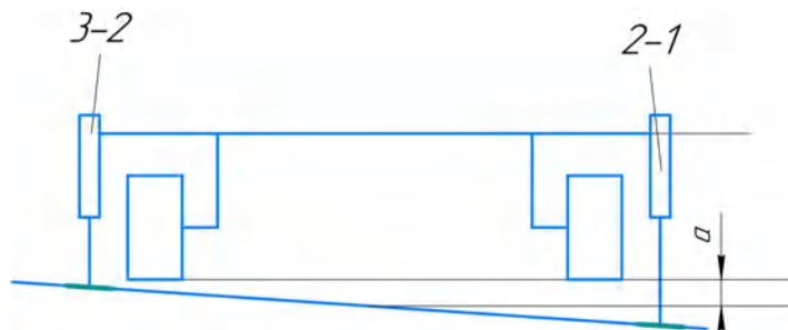
Рисунок 8.6 – Проекція після установки поперечної осі рами в горизонтальне положення
