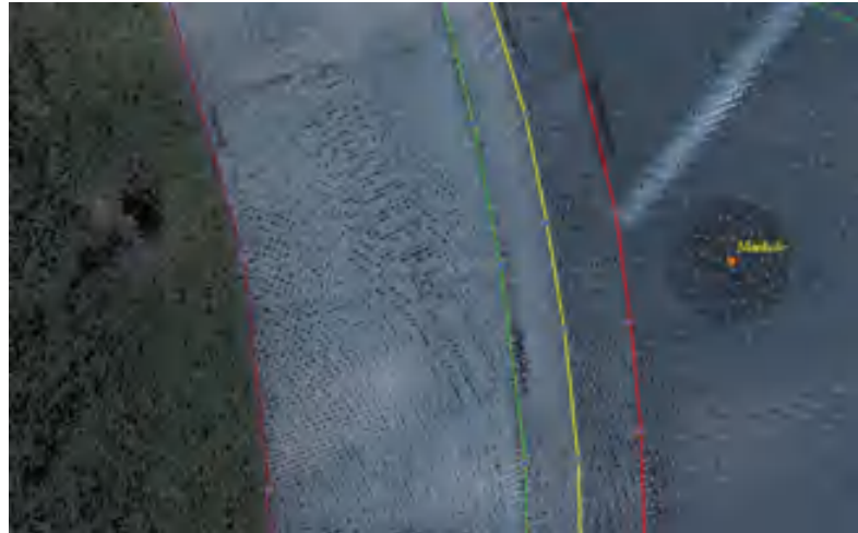
Рисунок 3.8 – Векторизовані бордюр, пішохідна доріжка та каналізаційний люк
