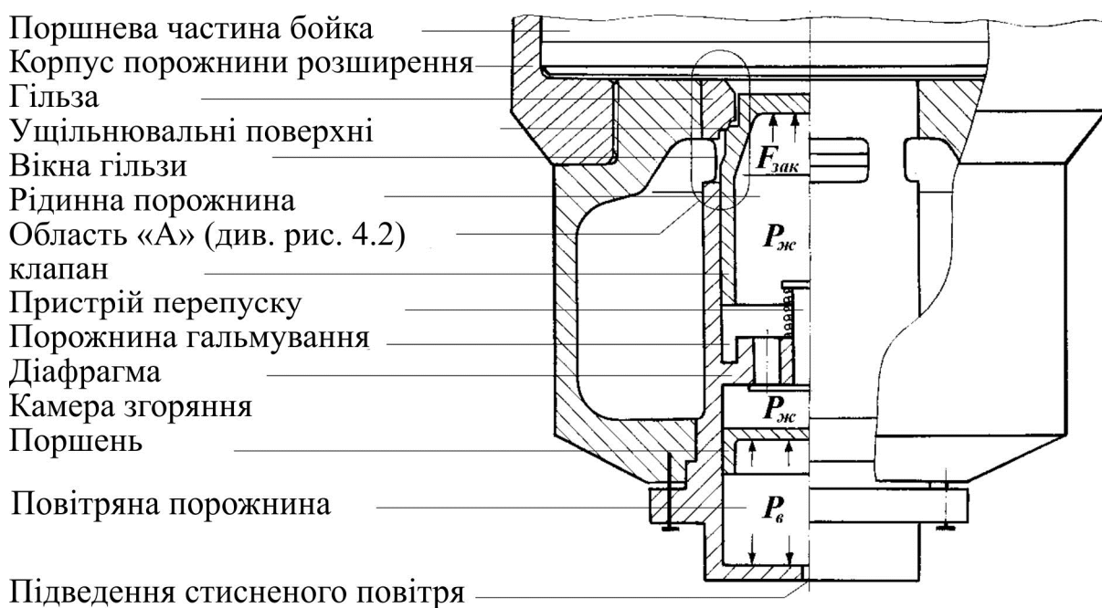
Рисунок 7.1 – Схема замикаюче-пропускного пристрою машини імпульсного різання [102]
