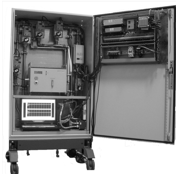
Рис. 3. Компоновка шкафа контроллера
