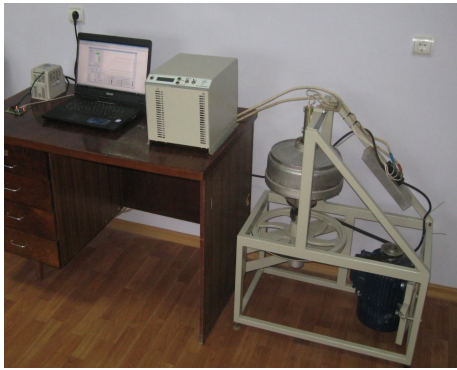
Рис. 4. Зовнішній вигляд випробувального стенду: де (зліва направо) перетворювач частоти, персональний комп'ютер, джерело безперебійного живлення ІБП-1,5/3С-ВГ/ФМ, електромеханічна частина стенду
