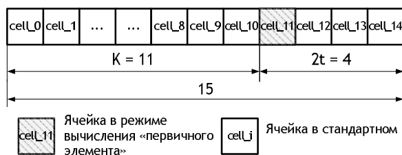
Рис. 2. Формирование структуры кодера с гибкой архитектурой для параметра кода РС (15, 11)
