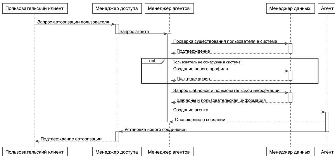
Рис. 4. Диаграмма межмодульных взаимодействий в процессе авторизации пользователя
