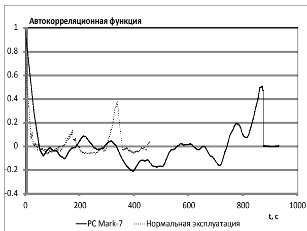
Рис. 6. Автокорреляционные функции для мощностей, потребляемых процессором в режиме обычного функционирования и под нагрузкой PCMark 7
