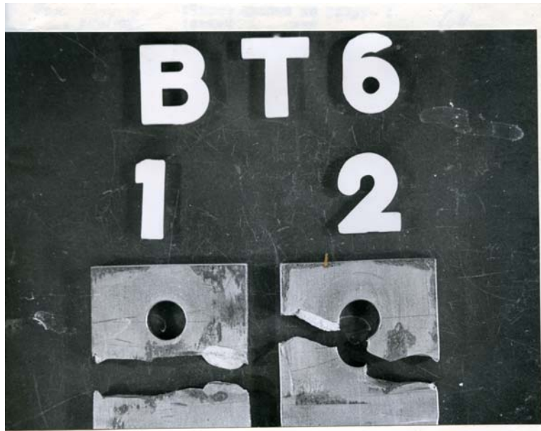
Рис. 10. Характер усталостного разрушения элементов двухсрезного соединения после упрочнения в зонах I и II. Болт установлен с \bar{\Psi} = 1,5 - 1,8 \% d
