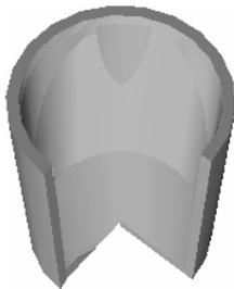
Рис. 4. Область впрыска в виде цилиндра с радиусом, равным радиусу отверстия впрыска реального двигателя
