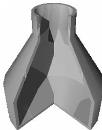
Рис. 5. Область впрыска в виде бутылки с радиусом горлышка, равным радиусу отверстия впрыска реального двигателя
