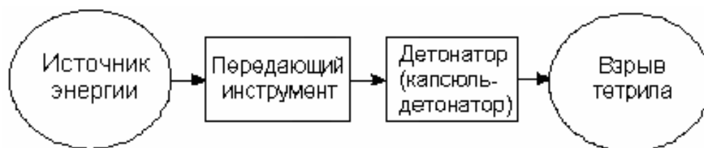
Рис. 6. Схема технологического процесса инициирования взрывателя методом удара
