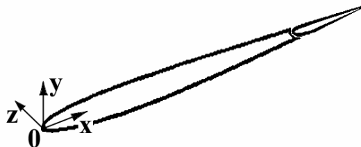
Рис. 3. Аэродинамический профиль киля и руля направления
