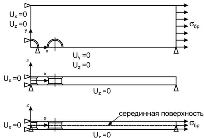
Рис. 5. Расчетная схема пластины с тремя отверстиями упрочняемой методом дорнования и выштамповки сегментных лунок: а – этап дорнования и извлечения дорнов; б – этап приложения растягивающих напряжений
