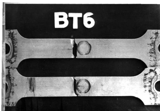
Рисунок 1 – Характер усталостного разрушения гладкой полосы из сплава ВТ6 в условиях фреттинг-коррозии при действии контактных давлений различной величины
