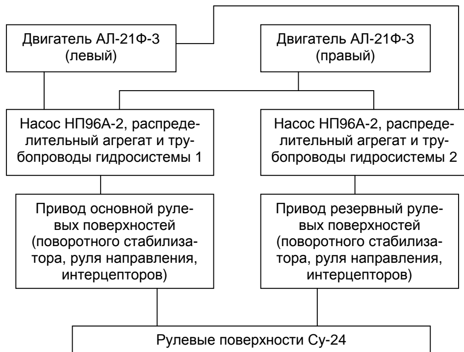
Рисунок 2 - Пример дублирования приводов несущих поверхностей Су-24
