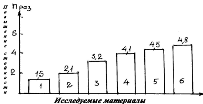
Рис. 5. Зависимость относительной стойкости ( n раз) от скорости нарезания резьбы при использовании различных СОСТ: 1 – ЖС-3; 2 – ЭП 33; 3 – ЭП 718, со смазкой НМ -1Ж; 4 – ЖС-3; 5 – ЭП-33; 6 – ЭП-718, со смазкой МР – 99; 7 – ЖС-3; 8 – ЭП-33; 9 – ЭП-718, с олеиновой кислотой.
