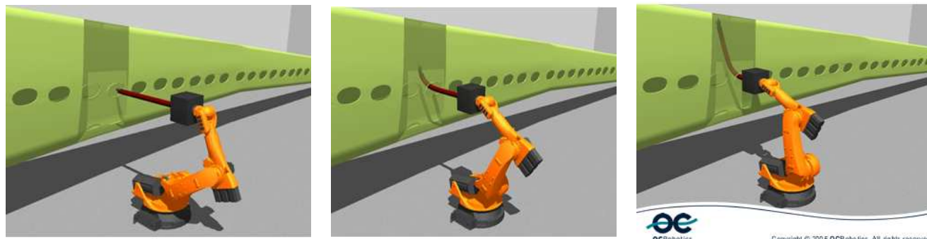
Рис. 24. Выполнение операций в кессоне крыла
