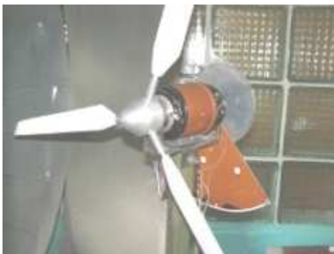
Рис. 1. Гондола действующей модели ветроэлектроустановки Генератор представляет собой многополюсную трехфазную синхронную машину с магнитной системой ротора «звездочка» с явно выраженными полюсами (полюсные башмаки отсутствуют). Конструкция сборного ротора содержит намаг-
