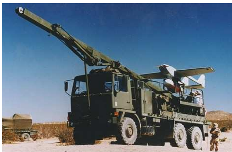
Рис. 2. Катапультная установка БПЛА Phoenix
