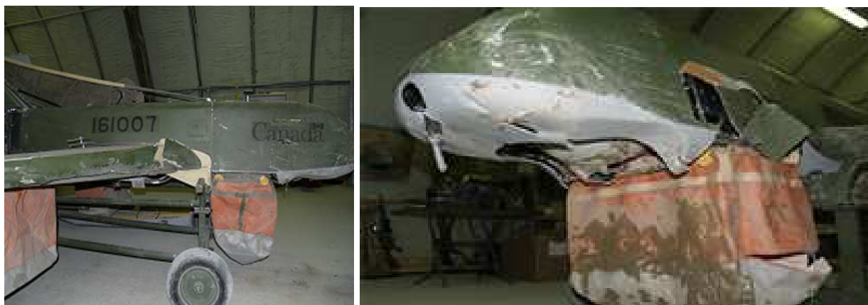
Рис. 3. Последствия аварийной посадки БПЛА Sperwer в Афганистане
