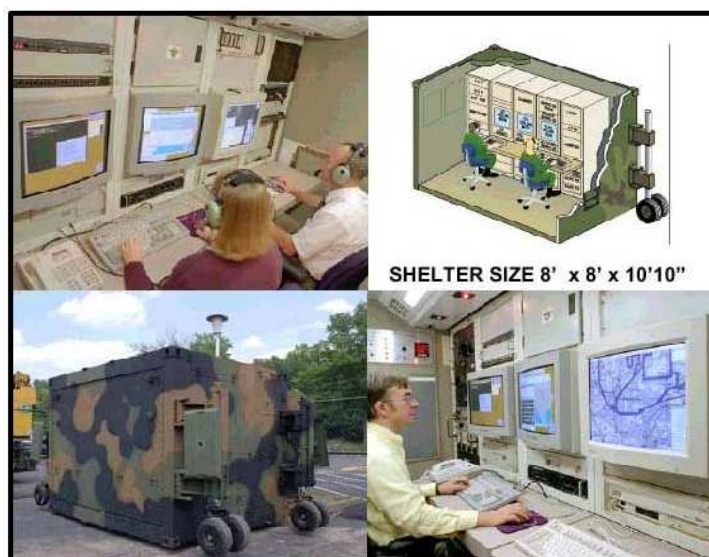
Рис. 4. Станция запуска и возвращения на землю БПЛА RQ-4A Global Hawk
