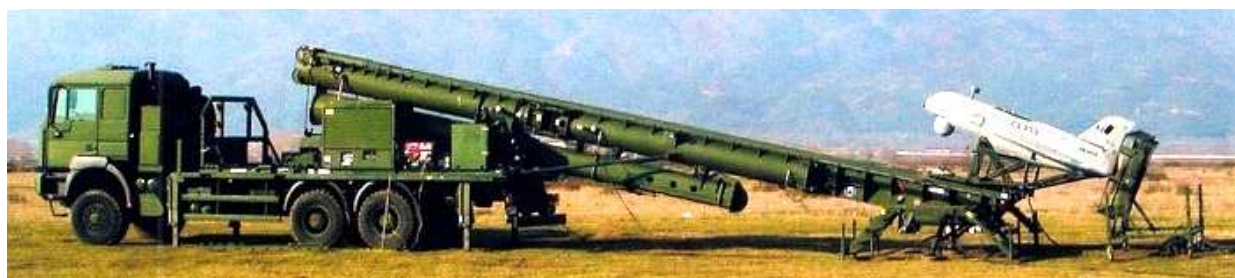
Рис. 1. Катапультная установка БПЛА Sperwer
