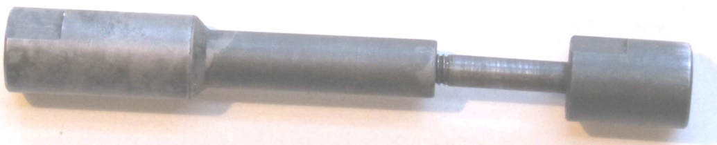
Рис. 12. Шток для передачи усилий
