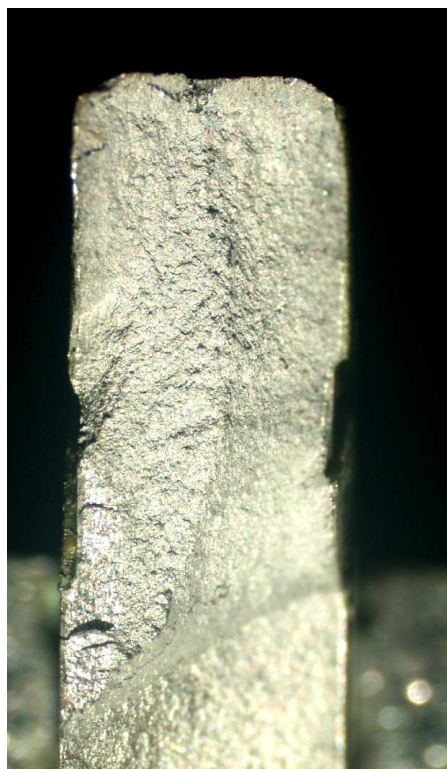
Рис. 27. Характер излома гладкой полосы с круговым барьерным обжатием после усталостного разрушения в условиях фреттинг-коррозии ( \times 6.5 , образец 2.2.2)
