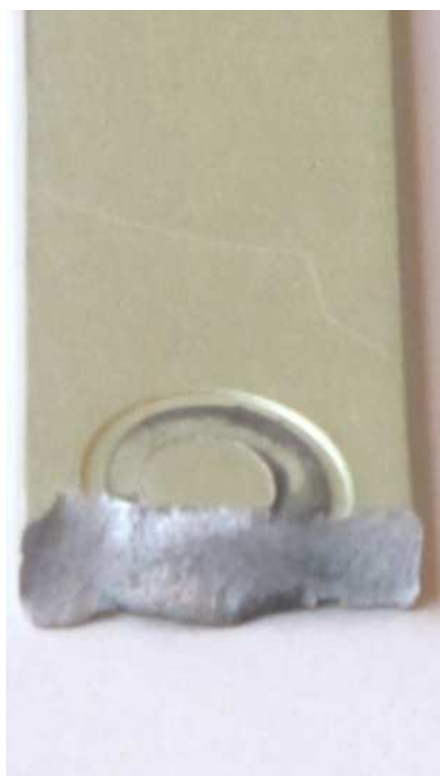
Рис. 26. Характер усталостного разрушения в условиях фреттинг-коррозии (образец 2.2.2)
