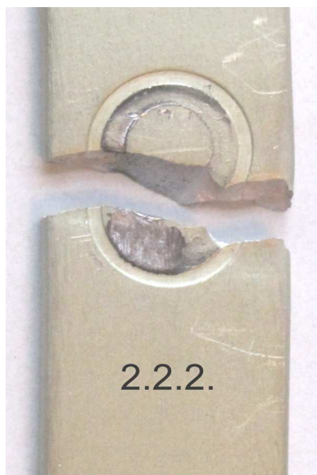
Рис. 25. Характер усталостного разрушения образцов гладких полос из материала Д16АТ л.5 с круговым барьерным обжатием в условиях фреттинг-коррозии в контактной паре с прижатыми шайбами 1,5 -8-16-ц ОСТ 1 34507-80 при уровне напряжений \sigma_{бр\ max} = 150 МПа
