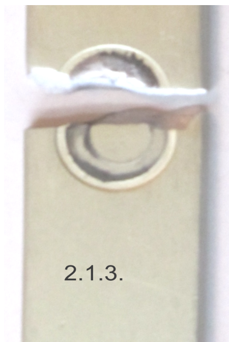
Рис. 24. Характер усталостного разрушения образцов гладких полос из материала Д16АТ л.5 с круговым барьерным обжатием в условиях фреттинг-коррозии в контактной паре с прижатыми шайбами 1,5 -8-16-ц ОСТ 1 34507-80 при уровне напряжений \sigma_{бр\ max} = 130 МПа
