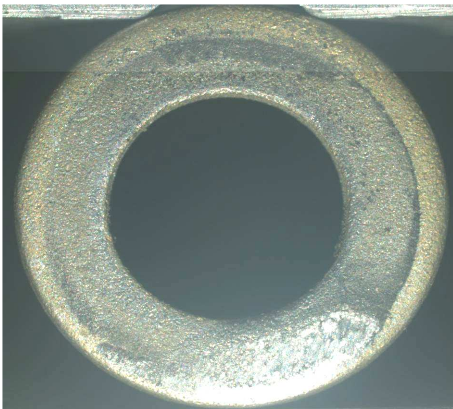
Рис. 29. Характер повреждения шайбы после испытаний ( \times 6.5 , шайба 2.2.2)
