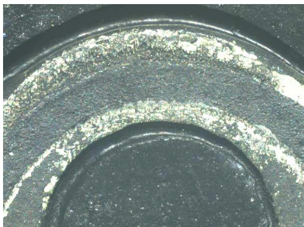
Рис. 36. Вид на поверхность гладкой полосы с круговым барьерным обжатием, заполненным герметиком У-30МЭС-5М после усталостных испытаний ( \times 11 , образец 3.1.2)
