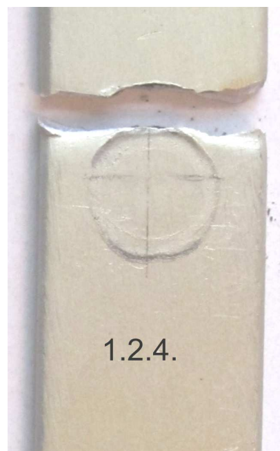
Рис. 16. Характер усталостного разрушения образцов гладких полос из материала Д16АТ л.5 при экспериментальных исследованиях в условиях фреттинг-коррозии в контактной паре с прижатыми шайбами 1,5 -8-16-ц ОСТ 1 34507-80 при уровне напряжений
