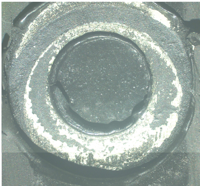
Рис. 34. Характерный повреждений полосы образца на поверхности гладкой полосы с круговым барьерным обжатием , заполненным герметиком У-30МЭС-5М (× 6.5, образец 3.1.2)
