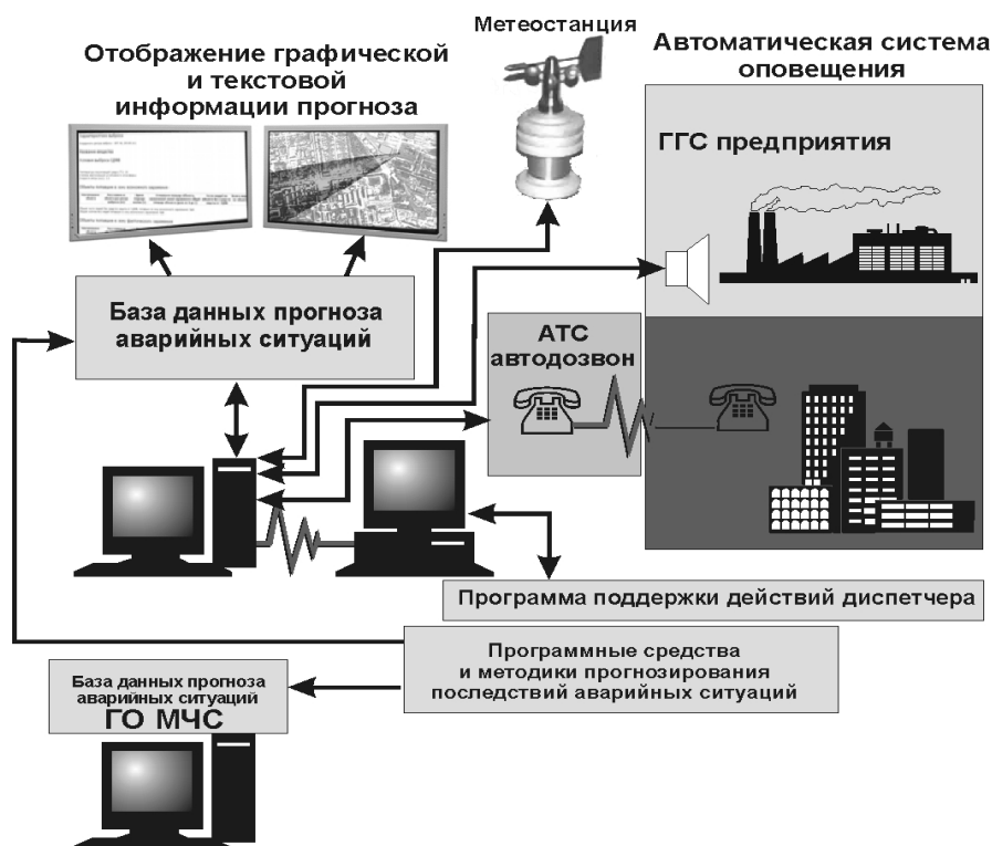
Рис. 1. Структурная схема автоматизированного программно-аппаратного комплекса поддержки принятия решений диспетчерской службы при возникновении и развитии аварий
