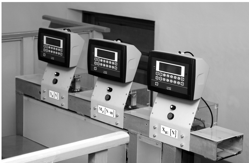
Рис. 5. Рабочее место операторов после модернизации измерительной системы АВТ-5
