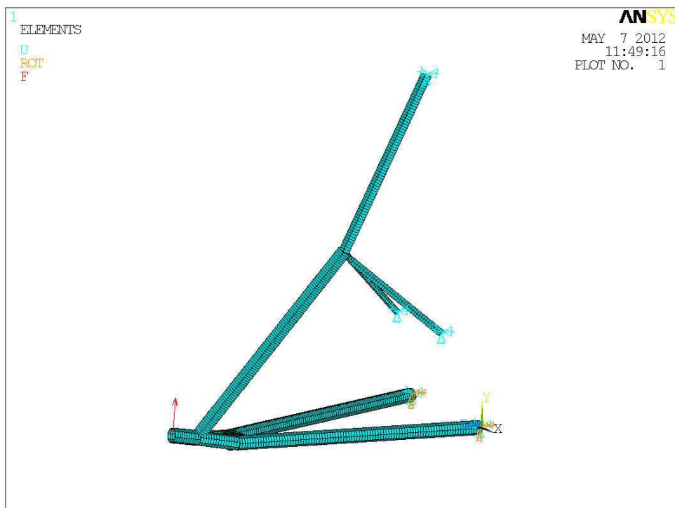
Рис. 5. Общая МКЕ модель стойки шасси и ее закрепление
