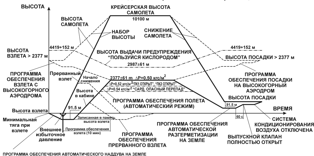
Рис. 6. Программа изменения давления и высоты в кабине самолета [3]
