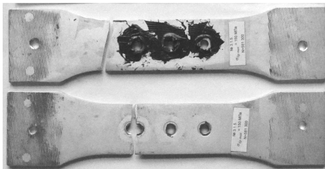
Рис. 20. Зона и характер усталостного разрушения моделей не нагруженного на срез продольного болтового соединения с осевыми и радиальными натягами с круговым барьерным обжатием, заполненных ВЗ-27м в зоне контакта головок болтов 8-34-Кд ОСТ1 31042-79 в плоскости контакта, в зоне прижатия специальными шайбами лунки – герметиком УЗОМЭС-5м после усталостного разрушения в условиях циклических растягивающих нагрузок при уровне напряжений \sigma_{бр\ max} = 150 мПа (образец 3.1.5)
