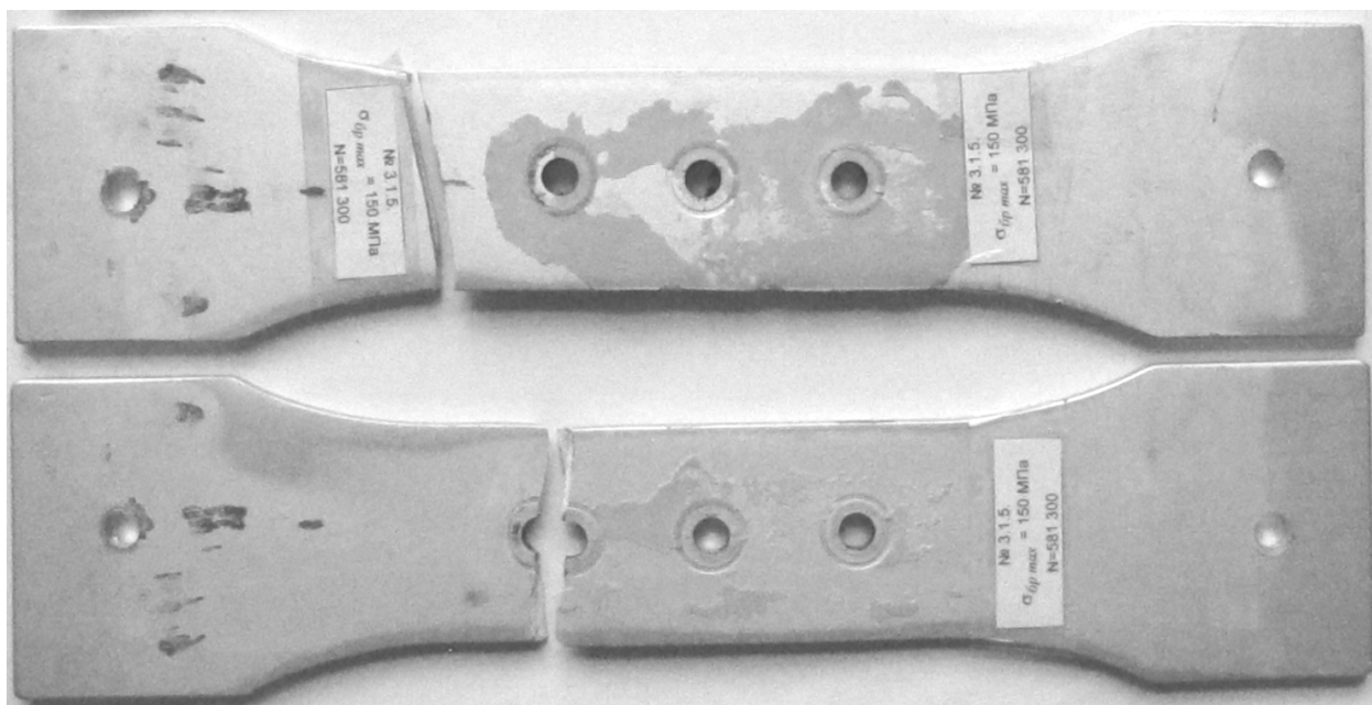
Рис. 21. Характер усталостного разрушения моделей не нагруженного на срез продольного болтового соединения в зоне соединения плоскостей полос с круговым барьерным обжатием, заполненных ВЗ-27м и в зоне прижатия специальными шайбами лунки – герметиком УЗОМЭС-5м после усталостного разрушения в условиях циклических растягивающих нагрузок при уровне напряжений \sigma_{бр max} = 150 МПа (образец 3.1.5)
