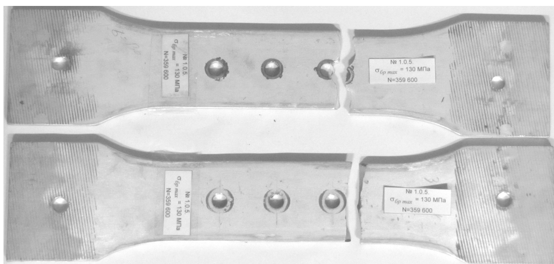
Рис.11. Зона и характер усталостного разрушения модели не нагруженного на срез продольного болтового соединения с осевыми и радиальными натягами при экспериментальных исследованиях в условиях фреттинг-коррозии в зоне контакта головок болтов 8-34-Кд ОСТ1 31042-79 и прижатými шайбами 1,5 -8-16-ц ОСТ 1 34507-80 при уровне напряжений \sigma_{\bar{b}p \max} = 130 МПа (образец 1.0.5)
