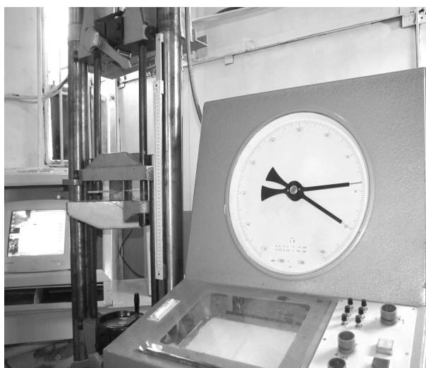
Рис. 7. Установка полосы для выполнения кругового барьерного обжатия на испытательной машине ZD 10/90
