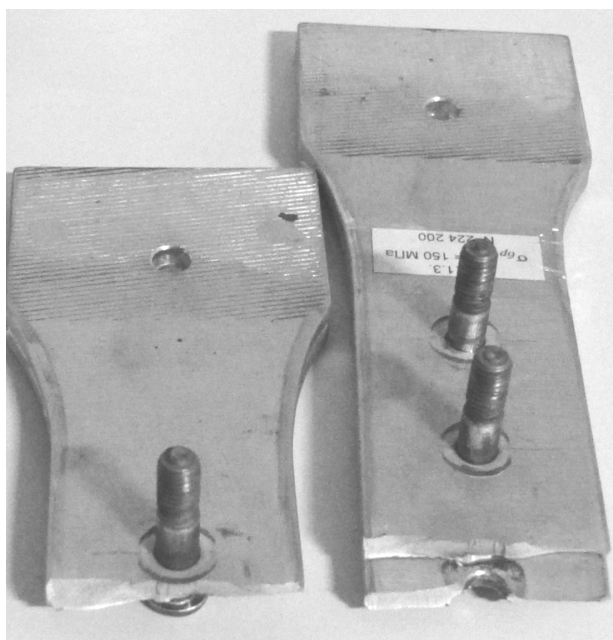
Рис. 14. Характер излома образца после усталостного, разрушения в условиях фреттинг-коррозии ( образец 1.1.3)
