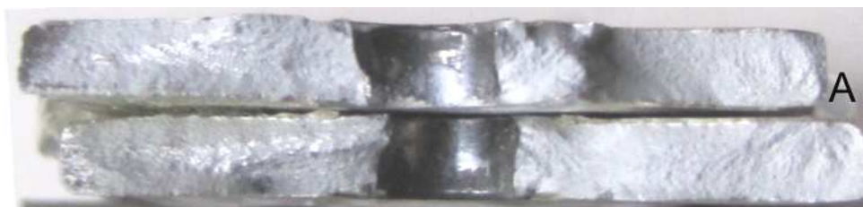
Рис. 18. Характер излома полосы с круговым барьерным обжатием, покрытой полимерным наполнителем после усталостного разрушения (образец 2.1.2)
