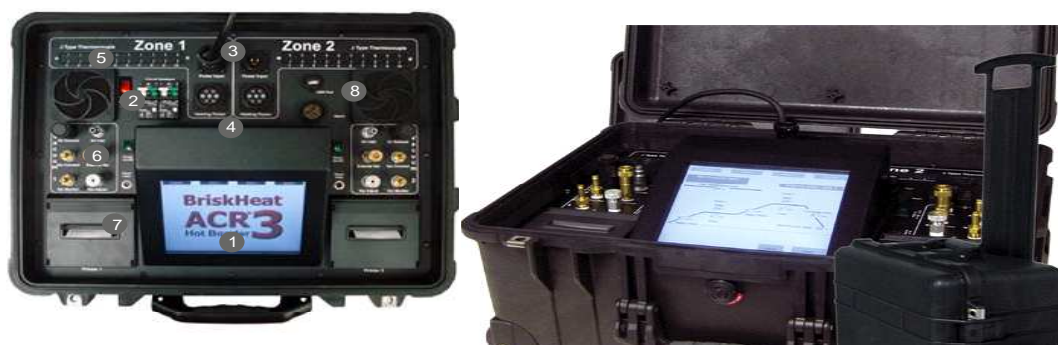
Рис. 4. Ручной компьютеризированный прибор Brisk Heat ACR-3 Hot Bonder и его технические характеристики: а) имеются две зоны контроля; б) напряжение при входе 100-130Вт, 200-240Вт в) диапазон рабочих температур от -20° до +60°; г) давление 27-28 дюймов рт. Ст. (13.26-13.75 PSI); д) возможно ручное регулирование давления для каждой зоны; е) управление температурой отверждения до 300 градусов, имеется 10 входов термопарных датчиков в каждой зоне
