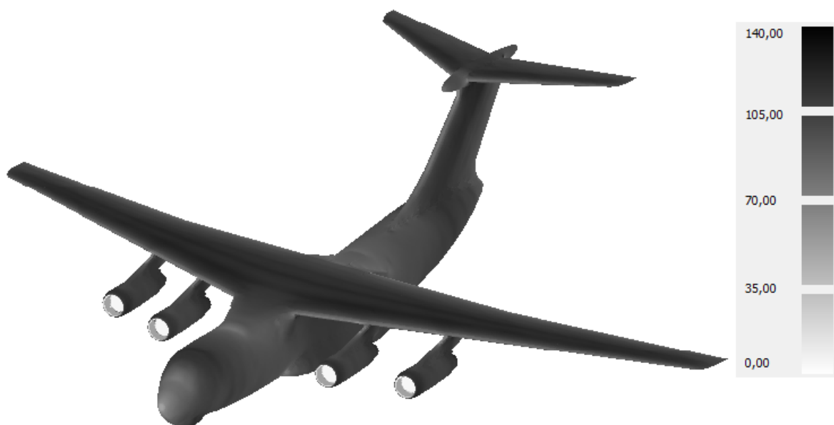
Рис. 6. Распределение модуля скорости вдоль поверхности летательного аппарата
