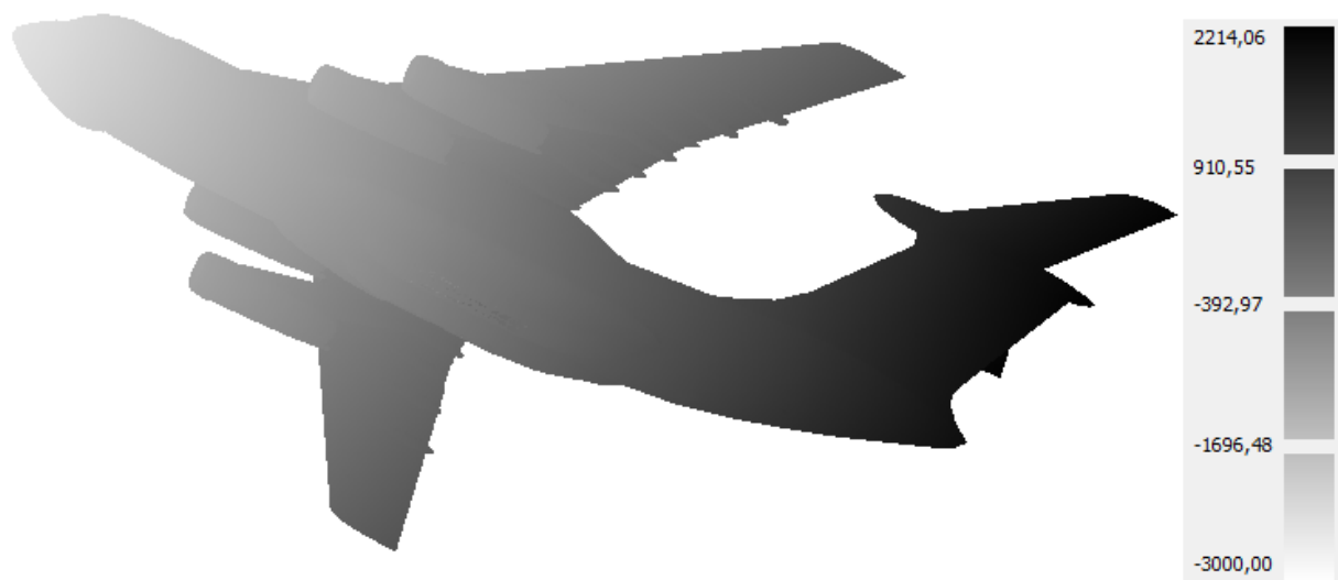
Рис. 5. Значения потенциала скорости на поверхности летательного аппарата
