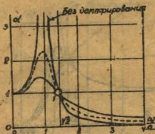
Рис. 466 Коэффициент трансформации в функции отношения \frac{\omega}{\Omega} для различных степеней демпфирования при F = A \cos(\omega t + \varphi)
