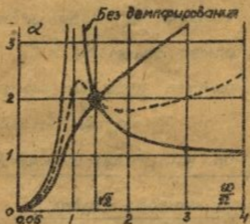
Рис. 467. Коэффициент трансформации в функции отношения \frac{\omega}{\omega_0} для различных степеней демпфирования при F = k \omega^2 \cos(\omega t + \varphi)
