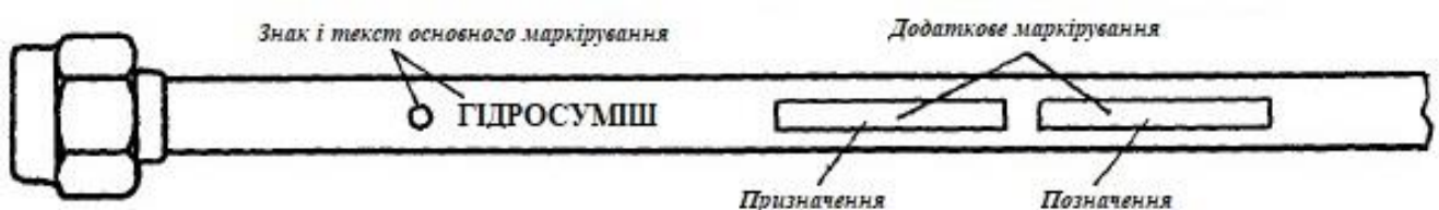
Рисунок 2.3 - Маркірування трубопроводів гідравлічної системи
