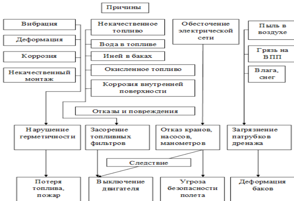
Рисунок 2.10 - Типові відмови та пошкодження елементів паливних систем
