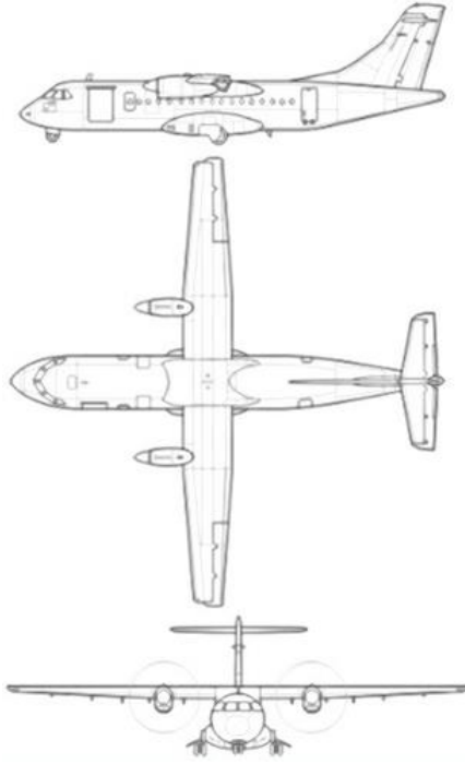
Рисунок 2 - Схема літака ATR 72
