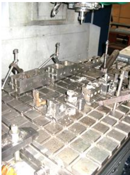
Рисунок 25 – УСП для кріплення заготовки у процесі формоутворення
