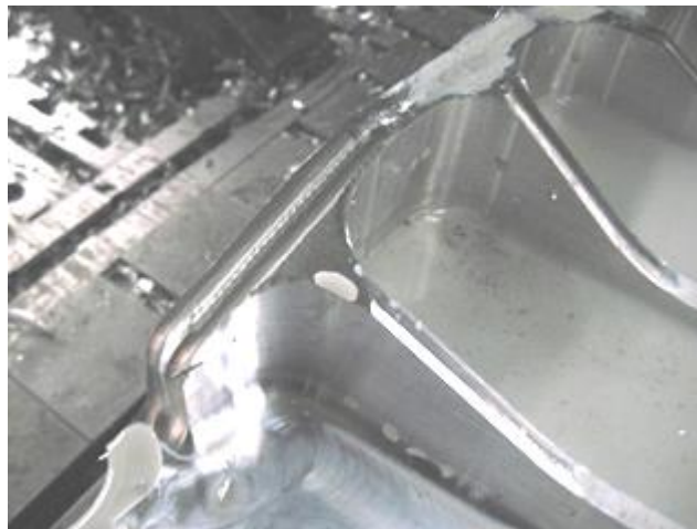
Рисунок 27 – Підрізання поверхні деталі у кутах колодязів
