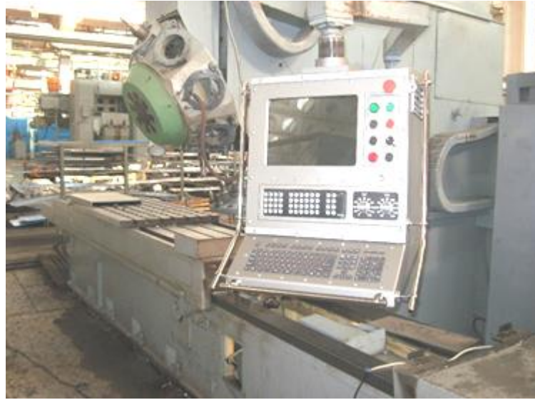
Рисунок 18 – Модернізований верстат ФП-7СМН5 з ЧПУ
