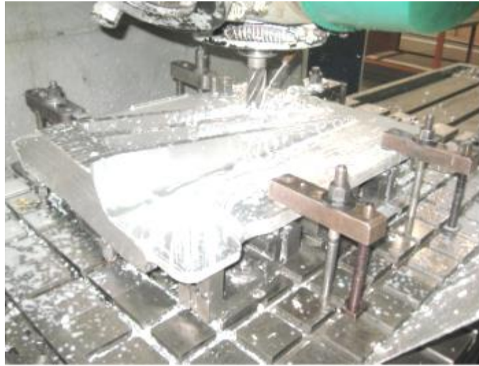
Рисунок 26 – Процес виготовлення серійного кронштейну
