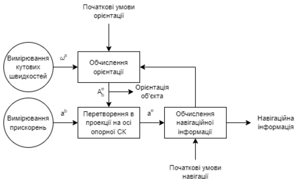
Рисунок 2.8 – Принцип роботи основного режиму БІНС
