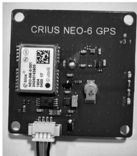
Рисунок 3.4 – Загальний вигляд модуля GPS типу CRIUS NEO-6GPS
