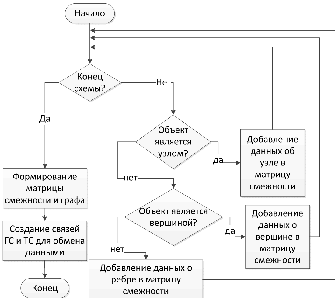
Рис. 3. Алгоритм построения гидравлической сети на базе технологической схемы
