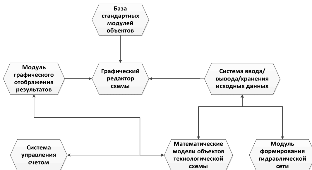
Рис. 5. Структурно-функциональная схема информационной технологии моделирования технологического процесса
