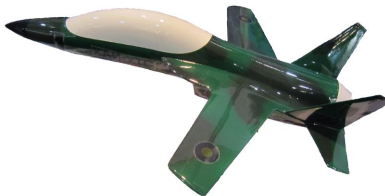
Рис. 12. Макет, созданный с помощью технологий 3D печати
