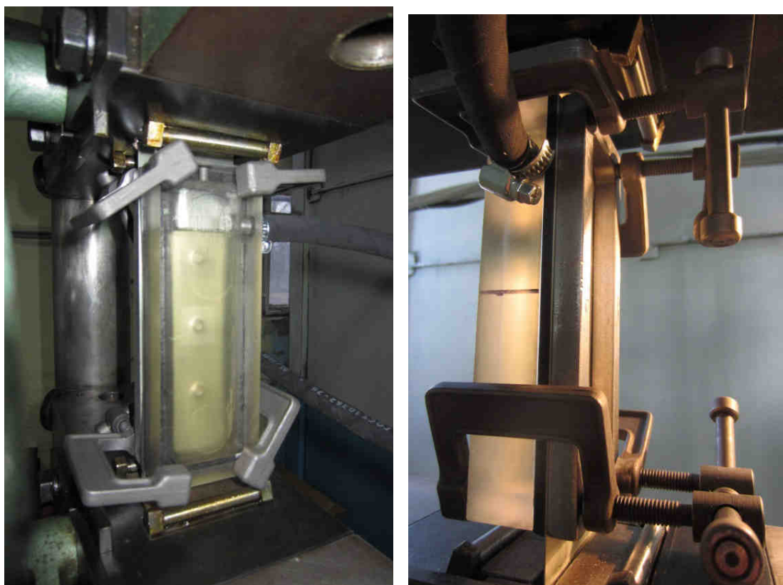
Рис. 5. Вид образца для испытаний на герметичность в захватах электромеханической разрывной машины ZD-10/90
