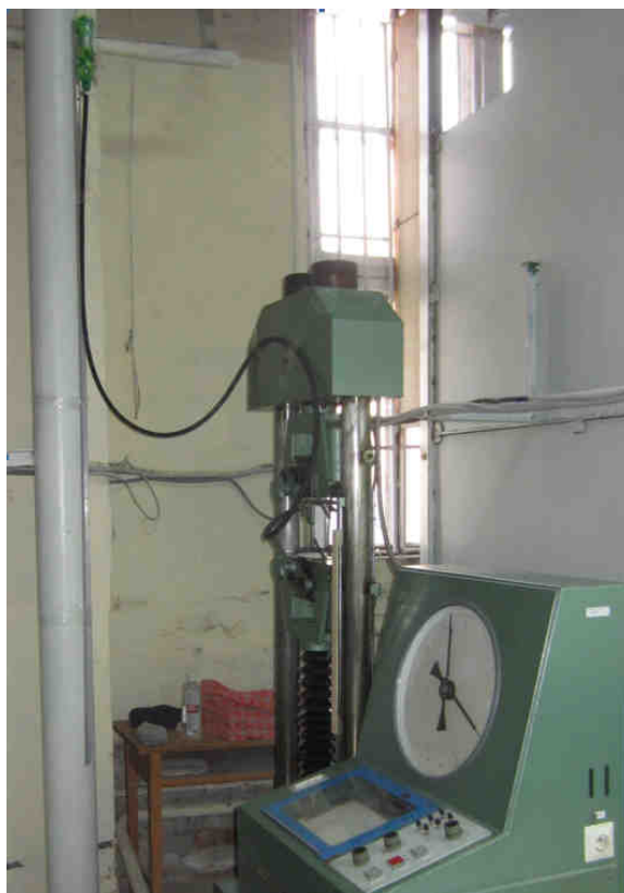
Рис. 4. Вид образца для испытаний в захватах электромеханической разрывной машины ZD-10/90
