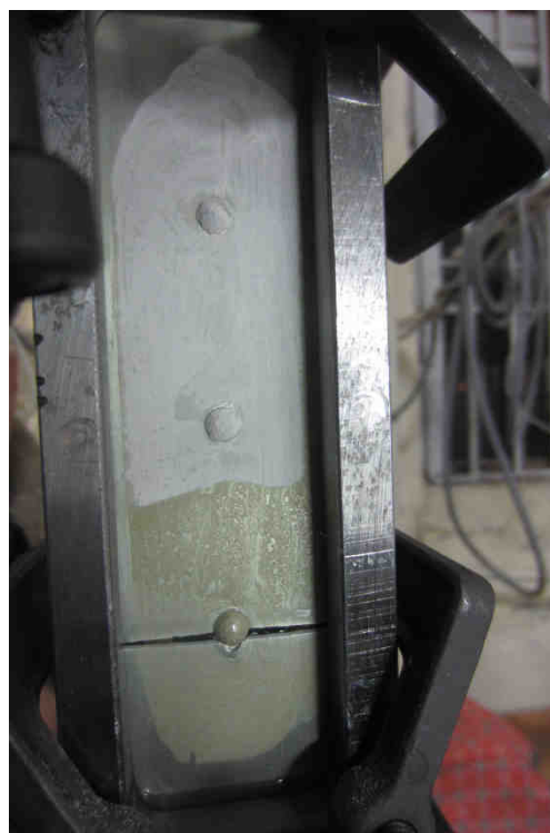
Рис. 9. Характер разрушения образца первой группы № 7.2.5-ВГ-Гр в сечении по оси отверстия крайнего ряда при P = 14\ 350 Н
