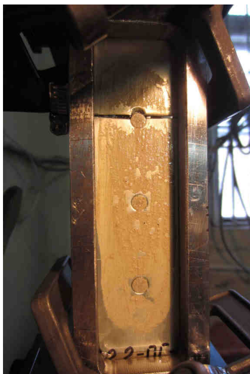
Рис. 8. Характер разрушения образца первой группы № 7.2.2-ПГ-Гр в сечении по оси отверстия крайнего ряда при P = 14\ 400 Н
