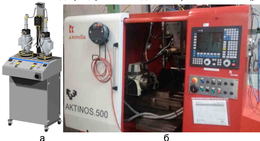
Рис. 4. Используемое оборудование: а – порошок питатель; б – 5-координатный фрезерный станок
