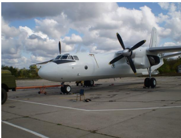
Рис. 6. Зважування літака на платформних вагах
