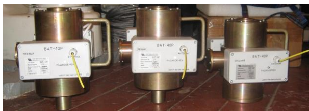
Рис. 2. Комплект вимірювальних блоків авіаційних ваг ВАТ-40Р
