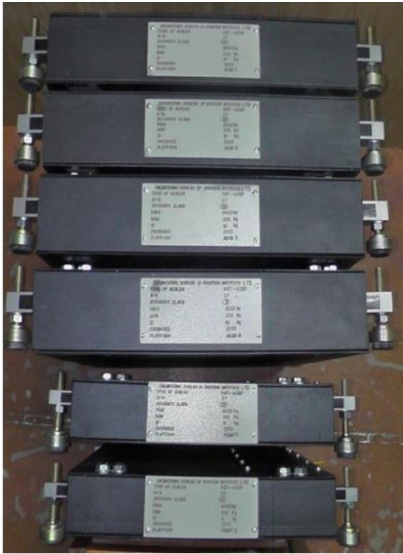
Рис. 1. Комплект ваговимірювальних платформ авіаційних ваг ВАТ-40РП
